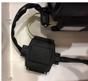
Die Erdungsschraube samt Unterlegscheibe, wie gezeigt, von außen nach innen festschrauben.
