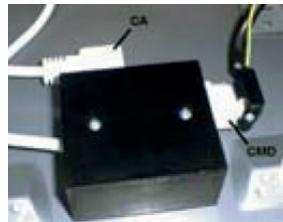
Den Deckel des Gehäuses so positionieren, dass die Löcher übereinstimmen und mit den mitgelieferten Schrauben befestigen.
