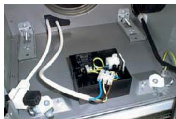
**Nel caso in cui sia presente il filo giallo/verde fissarlo alla vite di terra presente nella cappa, allo stesso modo collegare il filo giallo/verde che si trova nell'aspiratore remoto alla vite di terra dell'aspiratore.
