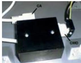
Положите крышку на коробку так, чтобы совместились соответствующие отверстия, свинтите их прилагаемыми в комплекте винтами.
