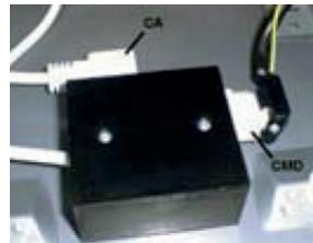
Pokrywę puszki umieścić w taki sposób, by odpowiadała pozycji otworów. Przymocować przy użyciu śrub na wyposażeniu.
