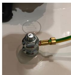
**Skontrolować, czy łącznik kabla zasilającego zainstalowany w puszce instalacji elektrycznej jest taki sam jak łącznik kabla zasilającego okap (jest uziemiony czy nie).**
