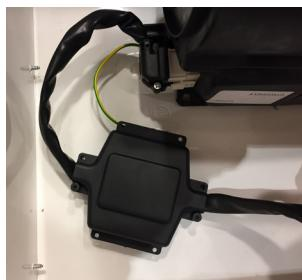
Śrubę uziemienia wsunąć od zewnątrz do wewnętrz, dokręcając podkładkę i śrubę, zgodnie z ilustracją.
