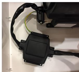
Introducir el tornillo de toma de tierra desde el exterior hacia el interior enroscando la arandela y el tornillo como se indica.
