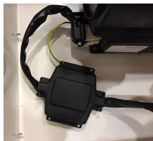
För in jordningsskruven från utsidan till insidan genom att skruva fast brickan och skruven enligt figuren.
