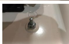
Insertar el cable con ojal en el tornillo de tierra y fijar todo con otra arandela y tuerca.
