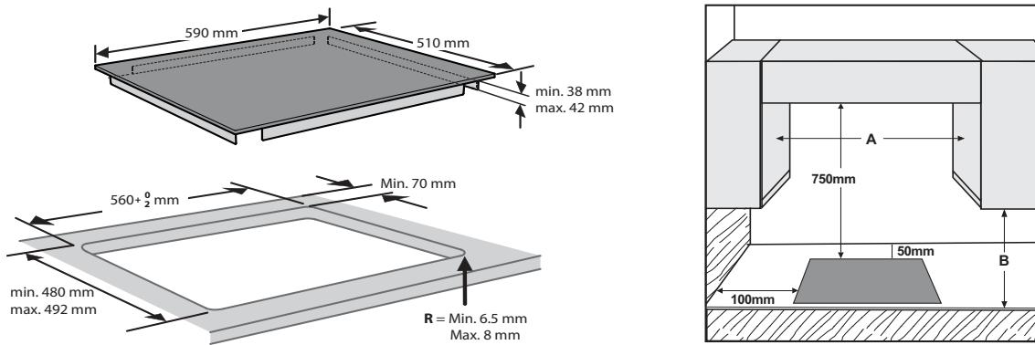
**ПРИМЕЧАНИЕ:** Если расстояние А между настенными шкафчиками составляет от 600 мм до 730 мм, то высота В должна быть не менее 530 мм. Если расстояние "А" между корпусами настенной мебели больше ширины варочной панели, то высота "В" должна быть не менее 400 мм. В случае установки над варочной панелью вытяжки необходимо соблюдать размеры, указанные в руководстве по эксплуатации вытяжки
