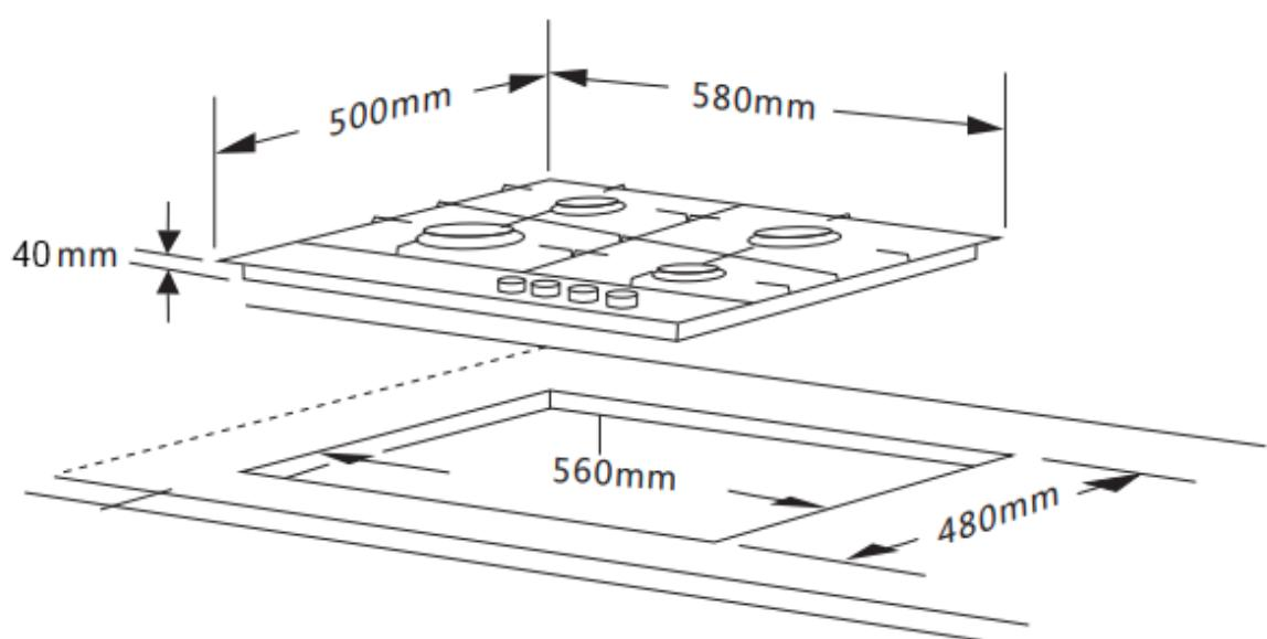
5. Кріплення (гачки, гвинти) для встановлення робочої поверхні розраховані для шаф товщиною від 20 до 40 мм.
