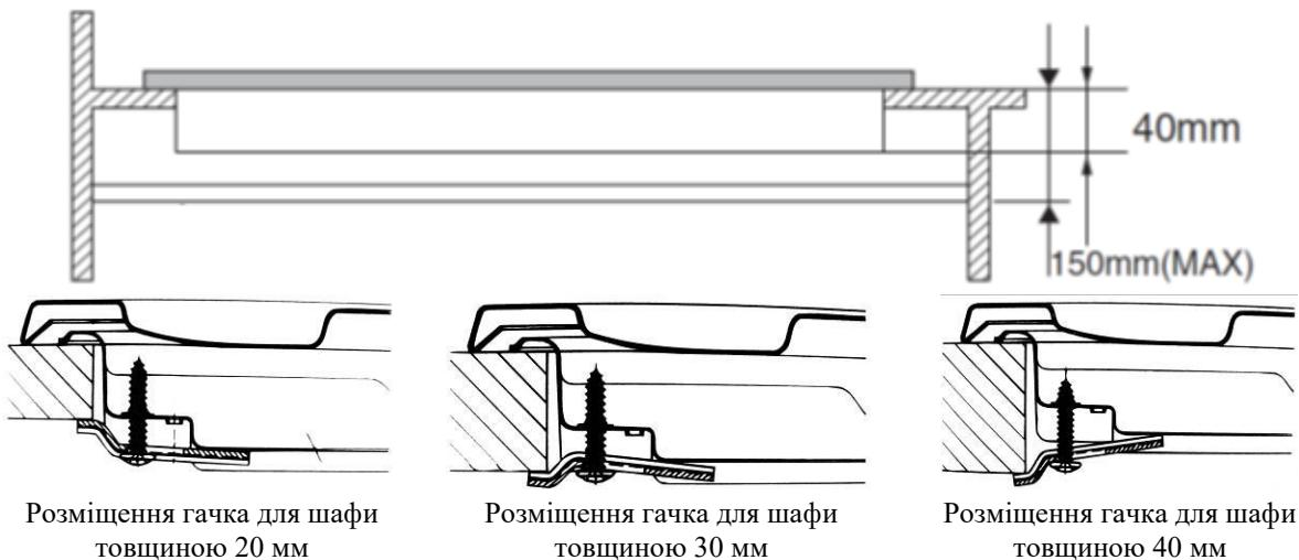
6. Якщо газова плита не встановлена над вбудованою духовкою, для ізоляції потрібно встановити дерев'яну панель. Панель повинна бути розміщена на відстані щонайменше 20 мм від нижньої частини пристрою.
