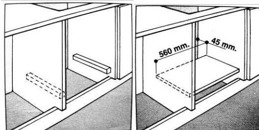
При встановленні варильної поверхні над вбудованою духововою шафою без примусової вентиляції переконайтесь, що Ви залишили вхідні та вихідні отвори достатнього розміру для адекватної циркуляції повітря.
